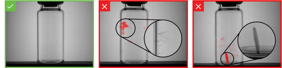
C360-IA Detección de ralladuras en viales transparentes antes del proceso de llenado.
