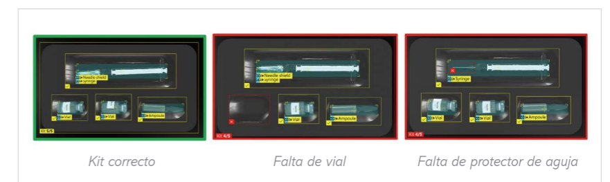
I-MRO Inspección de montaje con reconocimiento de objetos
